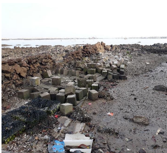
ภาพที่ 3.11 แบบหล่อคอนกรีตทรงลูกบาศก์ที่เผชิญสิ่งแวดล้อมทะเล
