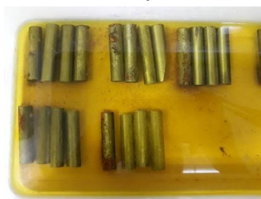
ภาพที่ 3.25 การแช่ตัวอย่างเหล็กเสริมลงในสารละลาย
