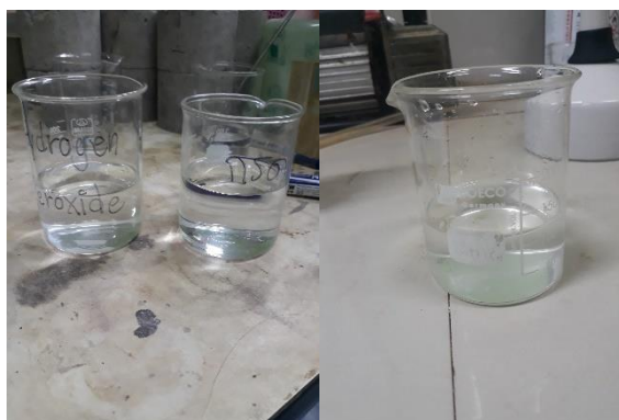
ภาพที่ 3.3 การเติมสารละลายกรดไนตริกและสารละลายไฮโดรเจนเปอร์ออกไซด์ลงในตัวอย่าง
