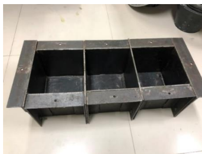
ภาพที่ 3.4 แบบหล่อตัวอย่างคอนกรีต
