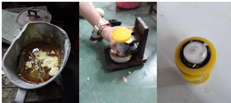
ภาพที่ 3.7 การปรับผิวหน้าตัวอย่างด้วยกำมะถัน
