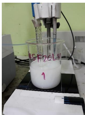
ภาพที่ 3.1 การไตเตรทหาปริมาณคลอไรด์
