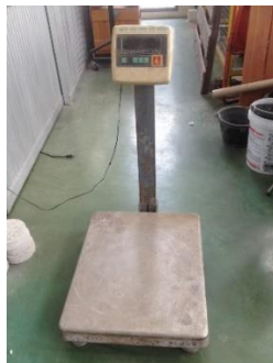
ภาพที่ 3.7 เครื่องชั่งดิจิตอล ความละเอียด 0.2 กิโลกรัม
