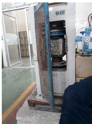
ภาพที่ 3.11 การนำก้อนตัวอย่างคอนกรีตไปกดให้เกิดรอย CRACK
