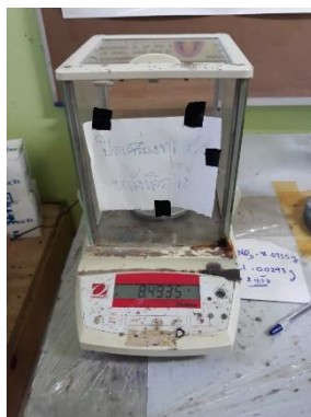
ภาพที่ 3.25 เครื่องชั่งดิจิตอล ความละเอียด 0.0001 กรัม
