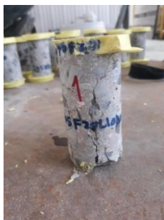
ภาพที่ 3.8 ลักษณะการวิบัติของตัวอย่าง
