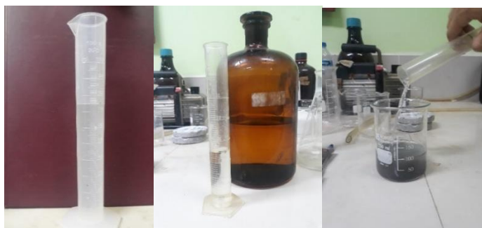
ภาพที่ 3.35 การเติมน้ำกลั่น และสารละลายกรดลงในตัวอย่าง
