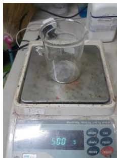
ภาพที่ 3.34 การชั่งผงคอนกรีต 5 กรัม
