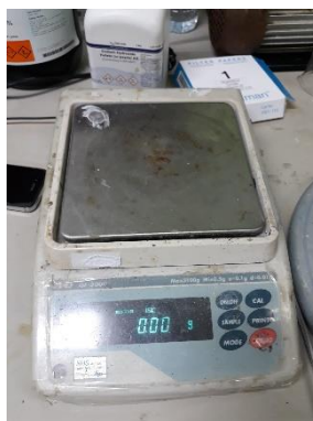
ภาพที่ 3.24 เครื่องชั่งดิจิตอล ความละเอียด 0.01 กรัม
