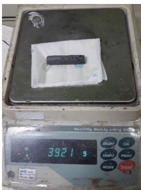
ภาพที่ 3.23 การชั่งน้ำหนักเริ่มต้นของเหล็กเสริมก่อนนำไปแช่สารละลาย
