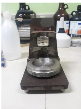
ภาพที่ 3.5 เครื่องปรับผิวหน้าคอนกรีต
